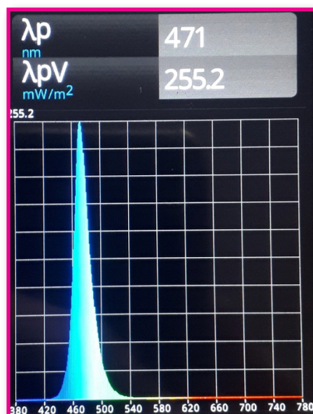
Рис 4. Спектр опромінення синім світлодіодом рослин приладом FLS 10s
