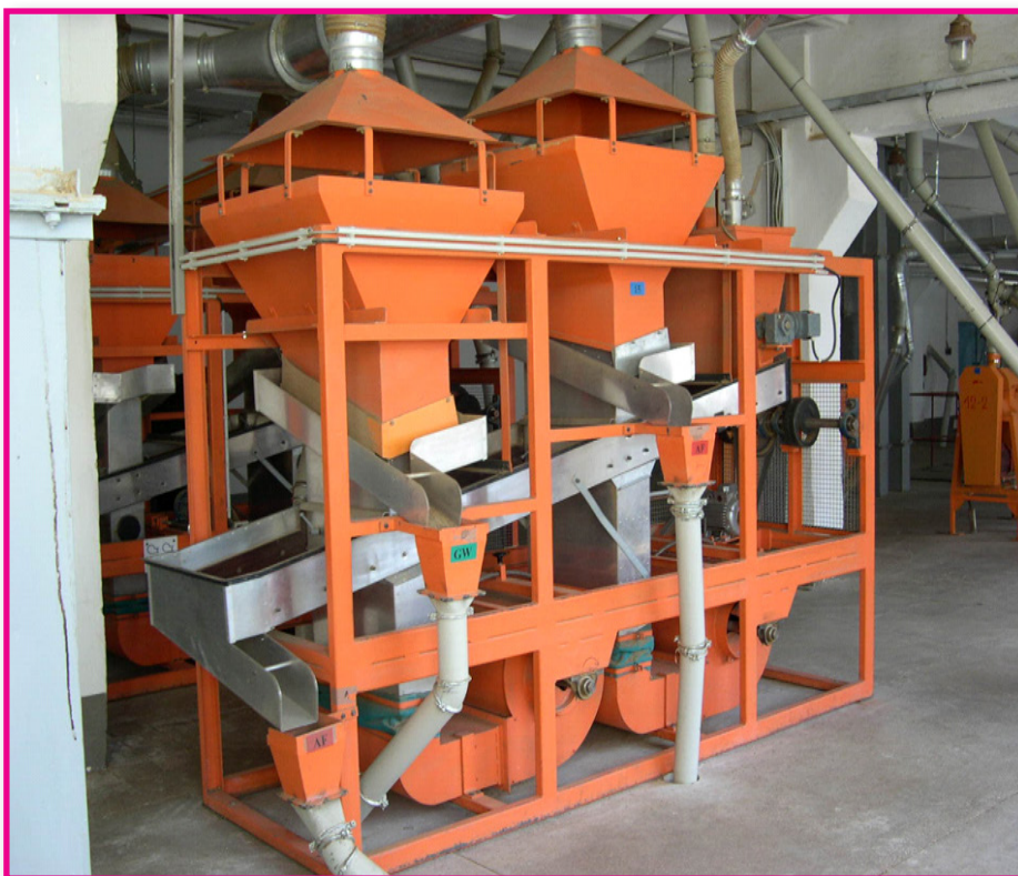
Рис. 2. Аспіраційна колонка для сортування насіння за аеродинамічними властивостями в промислових умовах
